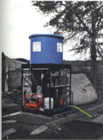
Sopra: Acquacube, usato a New Orleans dopo Katrina, è in grado di fornire circa 2.000 litri di acqua "buona" all'ora. Sotto: Play Pump, un'iniziativa di Trevor Field, è invece una giostra per bambini collegata a una pompa in grado di estrarre dal sottosuolo circa 1.400 litri all'ora
